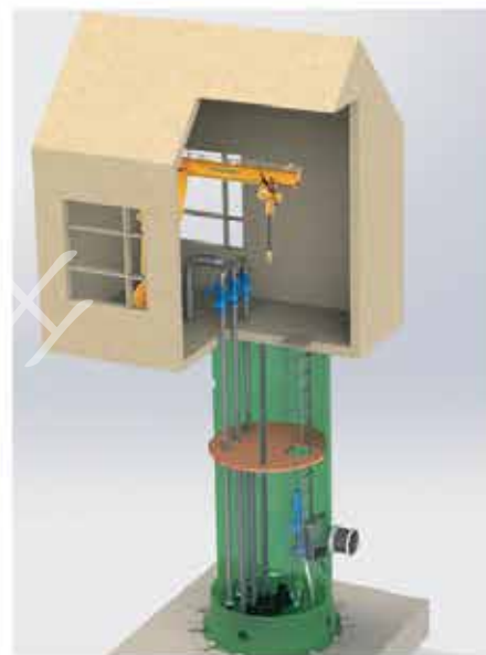
带维修间泵站
